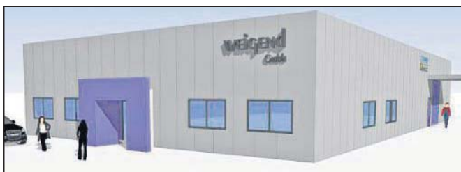
Das neue Produktions- und Bürogebäude wird in Stahlkonstruktion mit Sandwichelementen (Aluminium/Wärmedämmstoff) errichtet und soll Ende dieses Jahres bezugsfertig sein.
